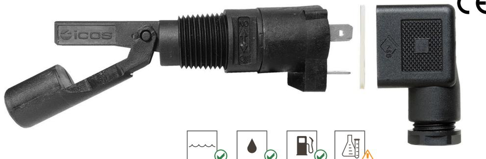
**Funcionamiento** El movimiento del flotador magnético abre/cierra un contacto eléctrico (reed switch).
