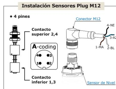
**¡Importante!** Conexión del Sensor con:
