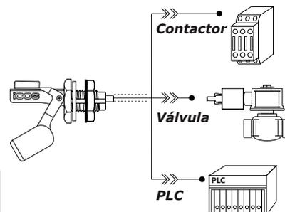
**¡Importante!** Conexión del Sensor con:
