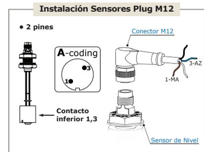
**¡Importante!** Conexión del Sensor con:
