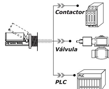
**¡Importante!** Conexión del Sensor con:
