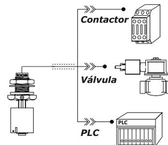
**¡Importante!** Conexión del Sensor con:
