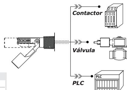
**¡Importante!** Conexión del Sensor con:
