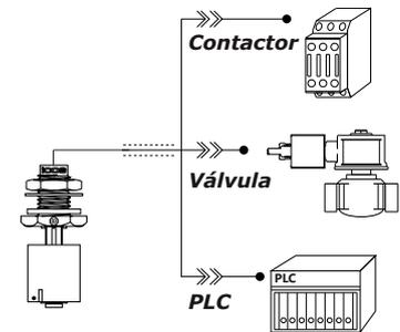
**¡Importante!** Conexión del Sensor con:
