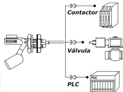
**¡Importante!** Conexión del Sensor con:
