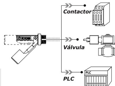
**¡Importante!** Conexión del Sensor con:
