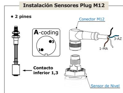
**¡Importante!** Conexión del Sensor con:
