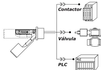
**¡Importante!** Conexión del Sensor con:
