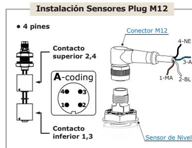
**¡Importante!** Conexión del Sensor con:
