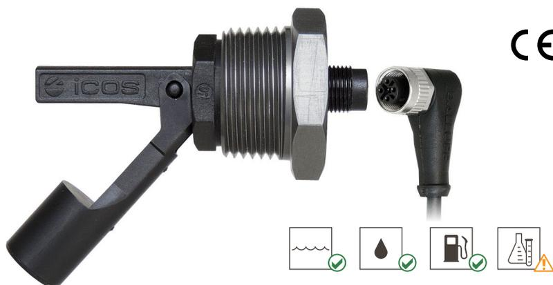
**Funcionamiento** El movimiento del flotador magnético abre/cierra un contacto eléctrico (reed switch).
