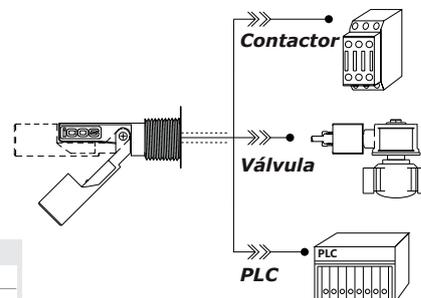
**¡Importante!** Conexión del Sensor con:
