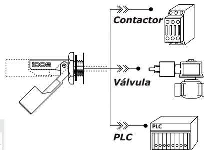
**¡Importante!** Conexión del Sensor con:
