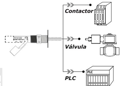
**¡Importante!** Conexión del Sensor con:
