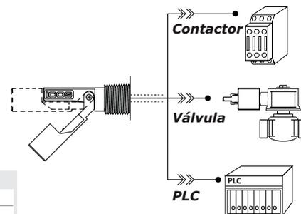
**¡Importante!** Conexión del Sensor con:
