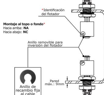
sensor de nivel | flotador de nivel | interruptor de nivel | regulador de nivel | indicador de nivel | control de nivel
